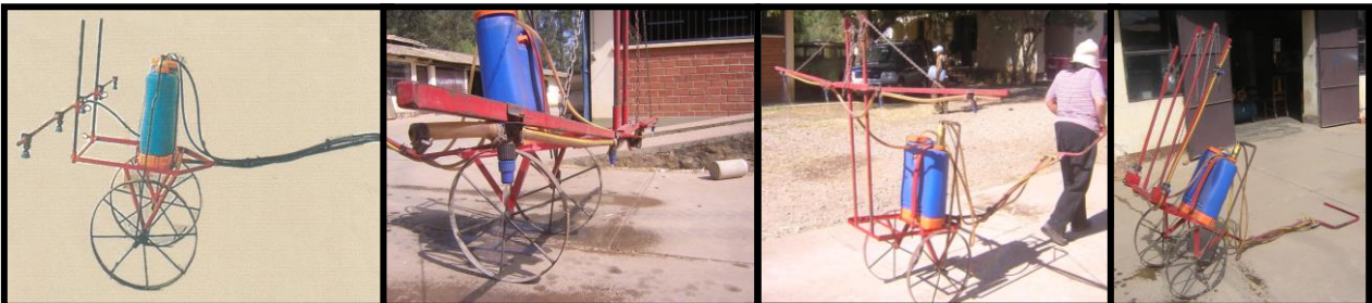
Aspersor accionado automáticamente, las cuatro boquillas tienen la misma presión La fumigadora unipersonal trabaja sola, no se la tiene que cargar, ni bombear con el brazo, sólo jalarla por los entre surcos
