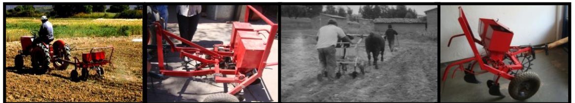
Al trabajar con la sembradora se siembra y se fertiliza al mismo tiempo tres surcos
