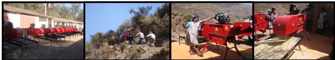
Trilladora T-1, el material trillado es cernido, para separar la paja del trigo
