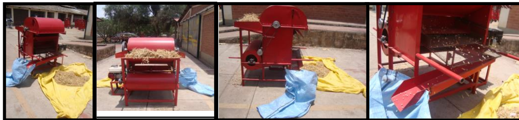
Trilladora de leguminosas, el material trillado se libera por la venteadora, el grano sale limpio
