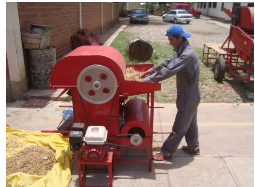
Trilladora de leguminosas, el material trillado se libera por la venteadora, el grano sale limpio
