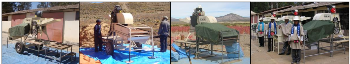
Trilladora TR-C, deposita el material trillado a un saco evitando así el contacto con la tierra
