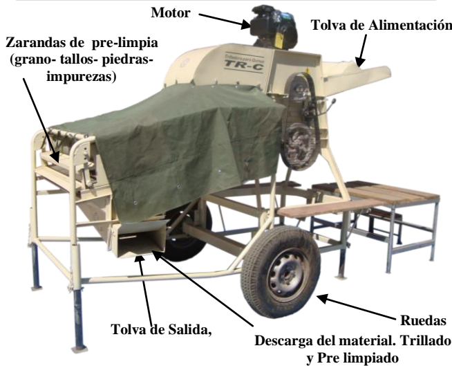
Trilladora TR-C instalada y lista para iniciar el trabajo de trilla
