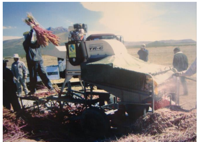
Trilladora TR-C, deposita el material trillado a un saco evitando así el contacto con la tierra
