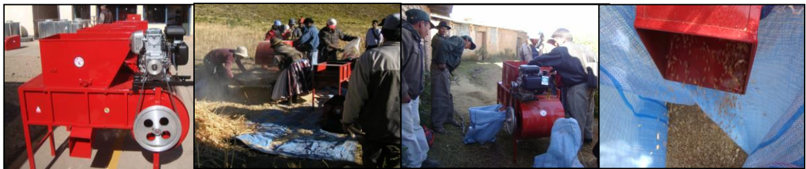
Venteadora V-1, limpia los granos de tierra, paja, piedras y otras impurezas
