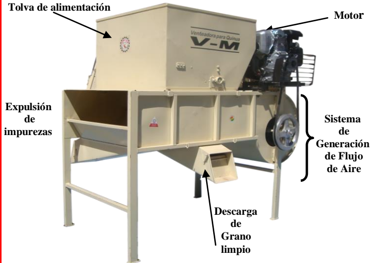
Venteadora V-M, instalada y lista para iniciar su trabajo de limpia de granos de quinua
